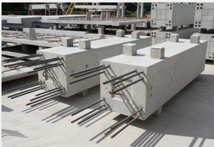
预制混凝土柱
