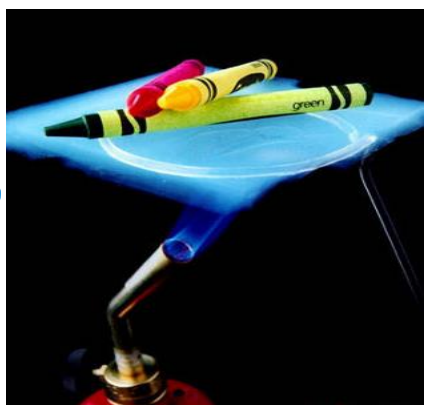
二氧化硅气凝胶 密度: 可低至 0.03\text{g/cm}^3
